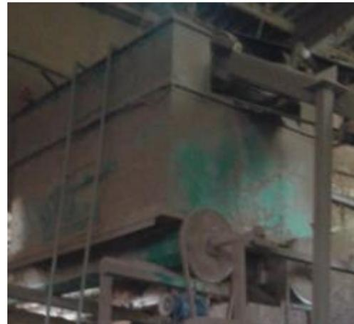
Fig. 07 Caixa de Alimentação material moído
