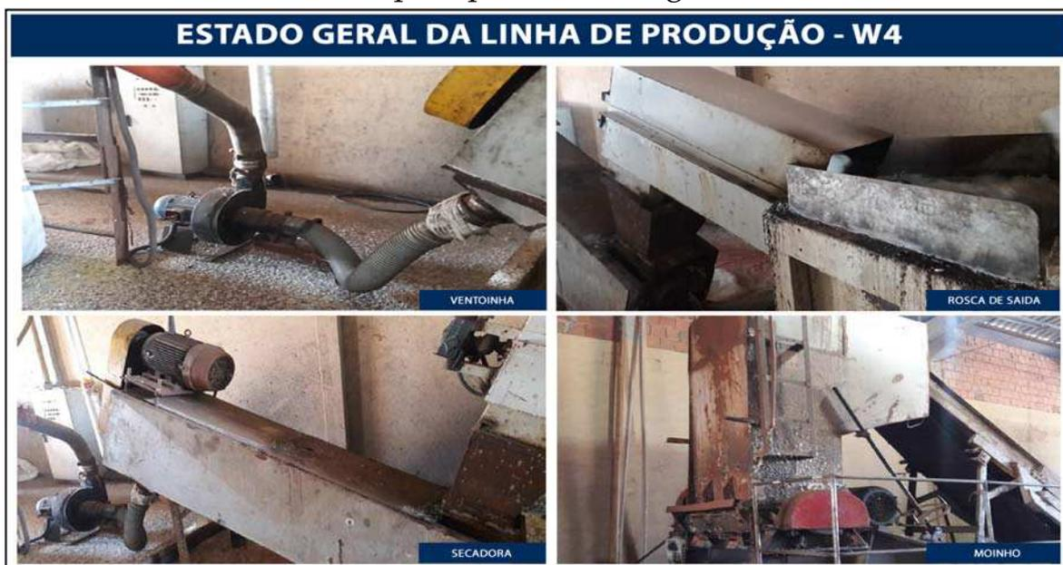
Noutro prisma, observou-se, ainda, a ausência de itens básicos de segurança nos pontos de esmagamento, agarramento e aprisionamento formados pelas esteiras, correias, roletes, acoplamentos, freios, roldanas, mostradores, volantes, tambores, engrenagens, cremalheiras, correntes, guias, alinhadores, região do estiramento e contrapeso e outras partes móveis acessíveis durante a operação normal, que precisarão ser adequados.
