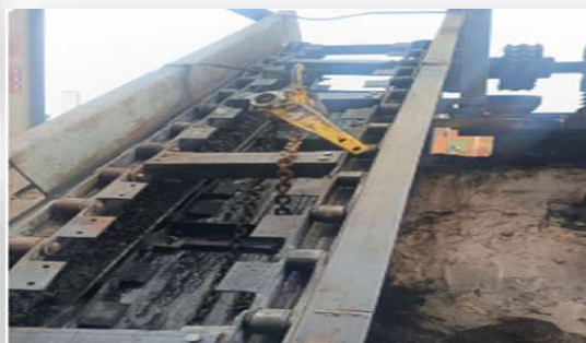
Troca das Palhetas do Redller e Cinza da Caldeira
