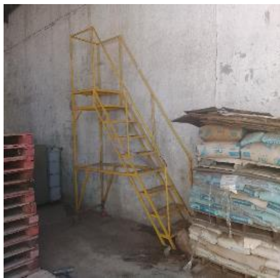
Escada de abastecimento c/9 degraus
